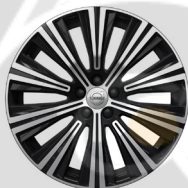
19 吋 10 輻黑鑽石切割 鋁合金鋼圈 Black Diamond Cut 255 / 40 R19
