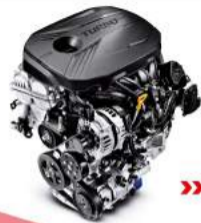
Gamma 1.6 Turbo GDi 渦輪增壓引擎
